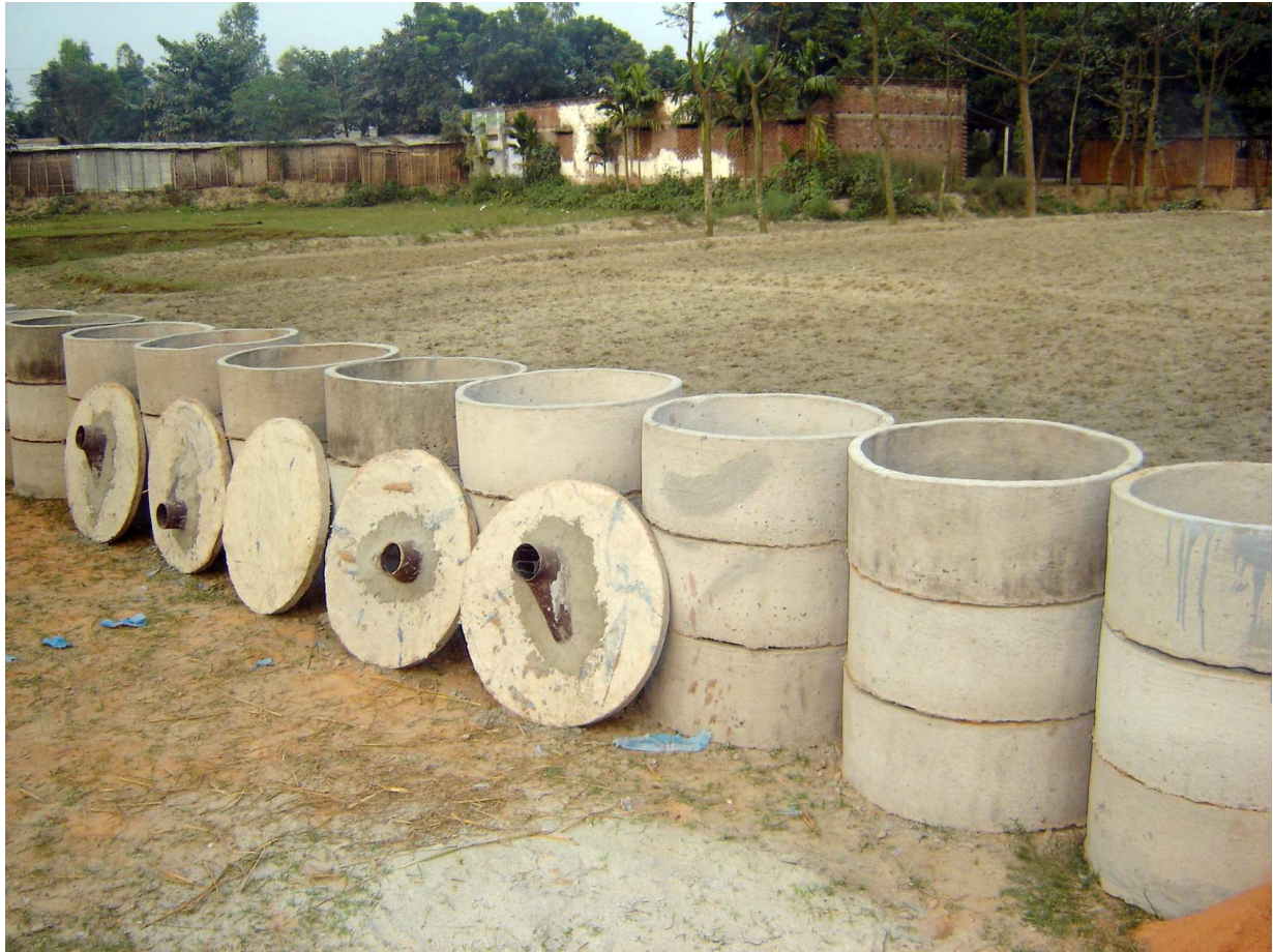
Figure 5.2 Couronnes et dalles de béton pour des latrines prêtes pour la vente.
